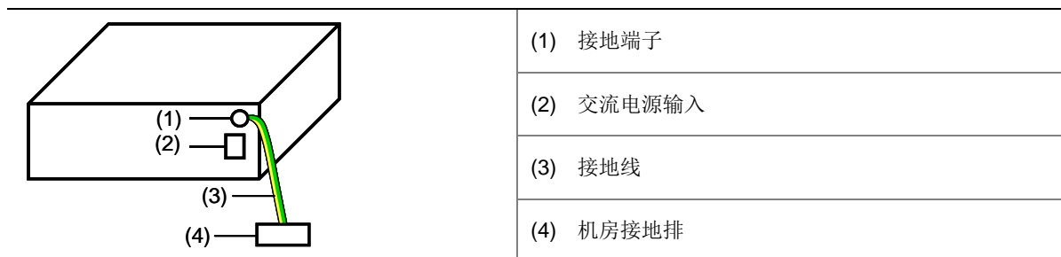
图2-12 接地安装示意图（机房有接地排）
