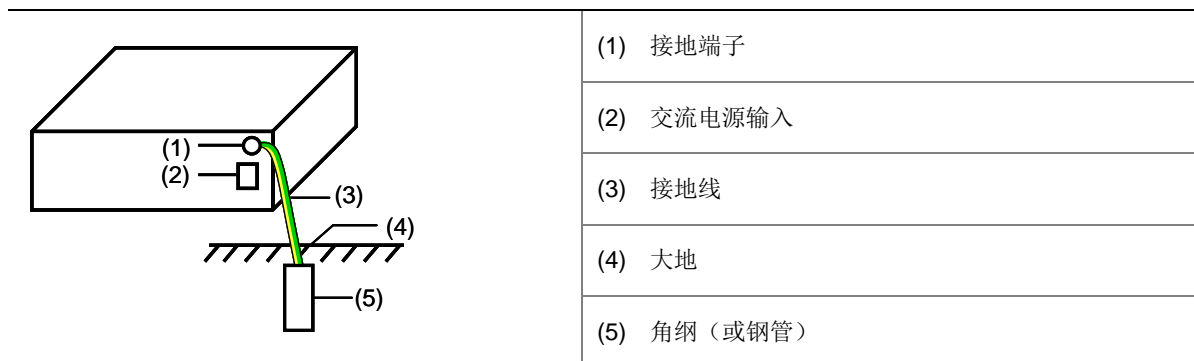
图2-13 接地安装示意图（埋设接地体）
